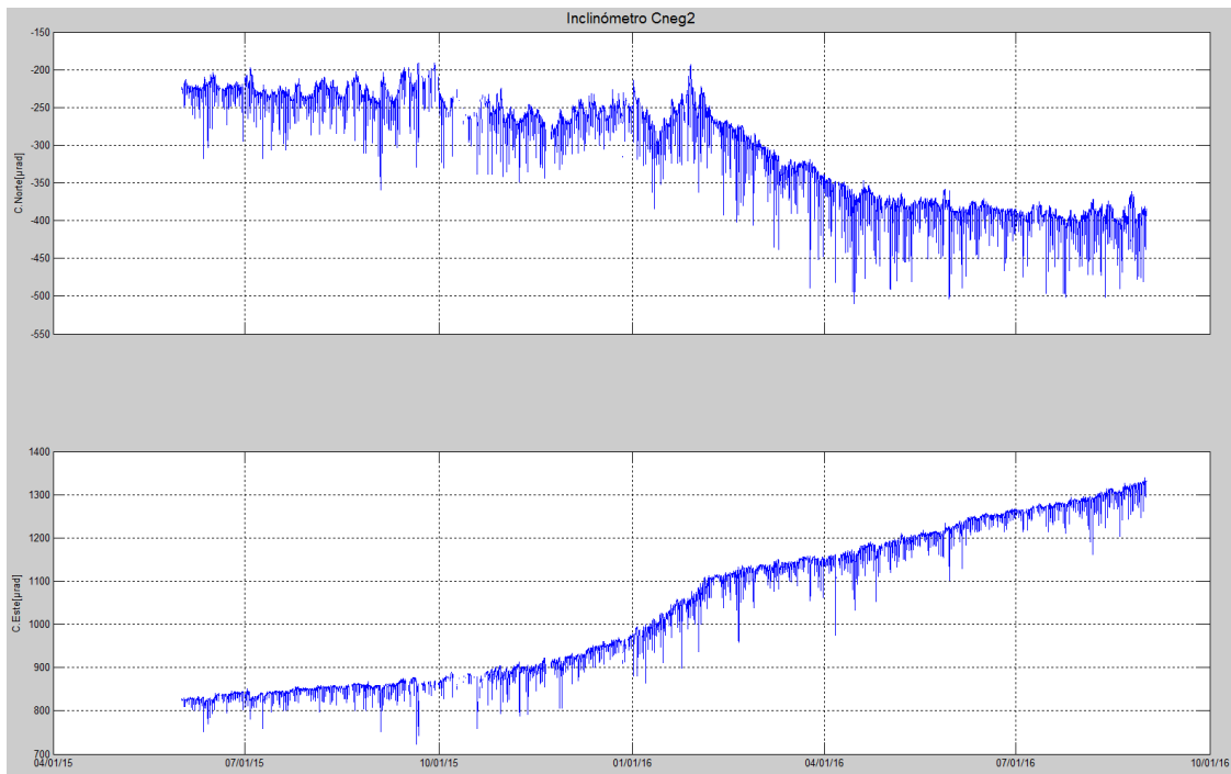
Figura 69. Componentes de inclinación Norte y Este, del inclinómetro electrónico Cerro Negro 2 (Cneg2), paralelo al inclinómetro Cerro Negro, instalado en el volcán del mismo nombre, para el periodo comprendido entre junio de 2014 y el 31 de agosto de 2016.
