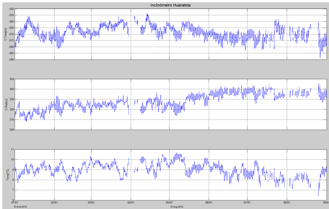
Figura 16. Componentes de inclinación Tangencial y Radial ( \mu\text{rad} ), registro de temperatura del inclinómetro electrónico Huairatola, instalado en Galeras, para el periodo comprendido entre el 1 de enero y el 31 de agosto de 2016.
